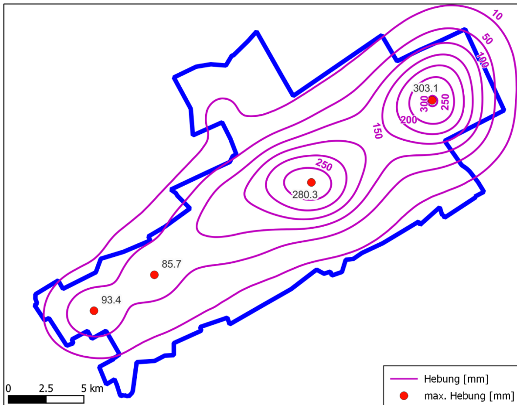
Abb. 5. Prognostizierte Hebungverteilung im Bereich der Wasserprovinz Haus Aden beim Grubenwasseranstieg bis zum Niveau von -380 m NHN.
